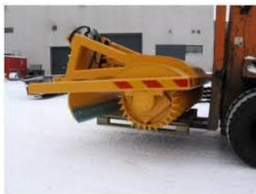
Modèle avec lame de raclage intégrée.
