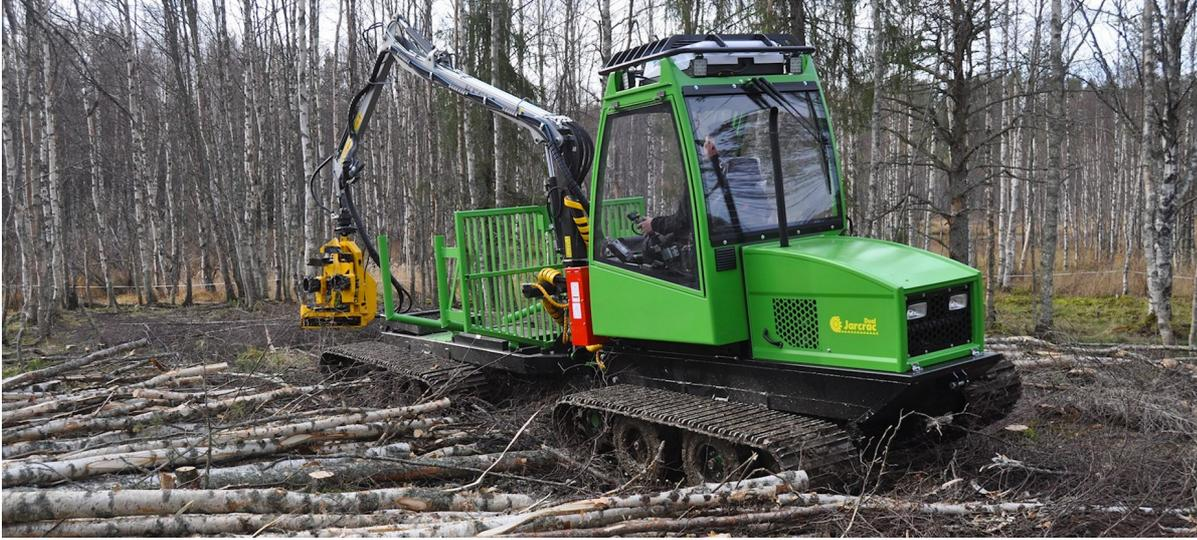
**Les Jarcrac sont des machines polyvalentes et modulables à faible impact au sol.**
